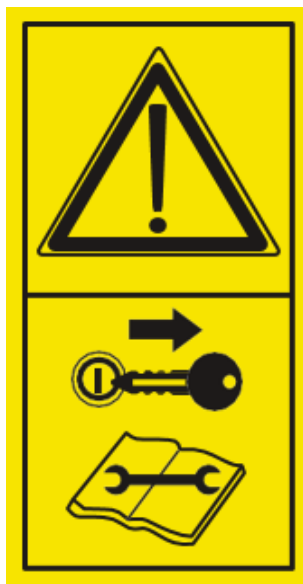
Figura 1-5: advertencia general de mantenimiento
