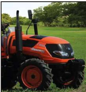
Capó del motor . La cubierta del motor del tractor está fabricada en una delgada y delicada lámina de metal con un estilo elegante para abrir el capó del motor tire del cable en el panel izquierdo del tractor.
