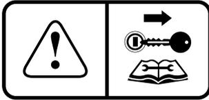
**Significado:** A priori a los trabajos de mantenimiento, servicio y ajustes técnicos, el motor debe desconectarse. Retire la llave y luego proceda según las indicaciones del fabricante.
