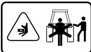
Significado: Manténgase a una distancia prudente cuando el sistema de palancas de elevación está funcionando, de otra forma se producirán heridas personales.
