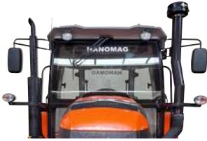
La cabina posee cuatro lámparas en total. Se encuentran separadas en la parte superior frontal. La lámpara frontal de la cabina se muestra en la figura. El cuerpo de la lámpara se puede girar según la necesidad.
