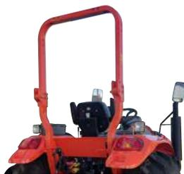
Esta estructura está compuesta de un marco rectangular de tubos de acero soldados. Esta estructura de seguridad es apta para girar hacia atrás y plegarse.
